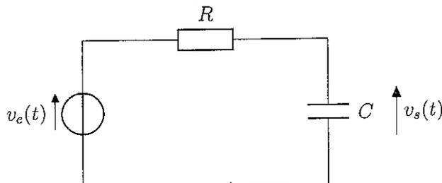
Les tensions d'entrée et de sortie sont de la forme :  $v_e(t) = V_e \cos \omega t$  et  $v_s(t) = V_s \cos(\omega t + \varphi)$ .
