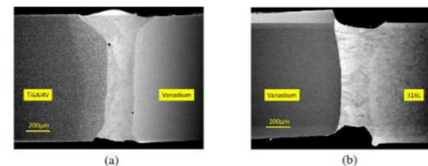
L'illustration ci-dessus montre un exemple d'assemblage Ti/V/Fe présentant une tenue mécanique de 500 MPa. L'assemblage nécessite 2 cordons avec dans l'ordre cordon Ti6Al4V/Vanadium, puis Vanadium/316L [1].
