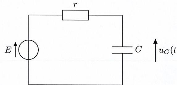
Lorsque le condensateur est chargé, l'interrupteur est basculé en position 2 et le schéma équivalent est donné ci-contre. On prend comme nouvelle origine des temps  $t = 0$ , le moment où l'on bascule l'interrupteur et  $u_C(0) = E$ .
