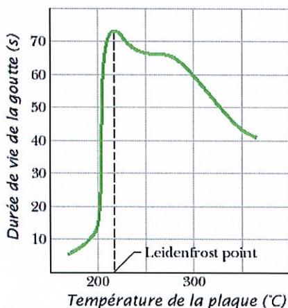
Les cuisiniers utilisent un test très simple pour vérifier la température d'une plaque destinée à griller de la viande. La température optimale doit être proche de 180°C. Le test consiste à projeter des gouttes d'eau sur la surface de la plaque. On doit observer un déplacement très rapide et désordonné des gouttes d'eau puis leur disparition.
