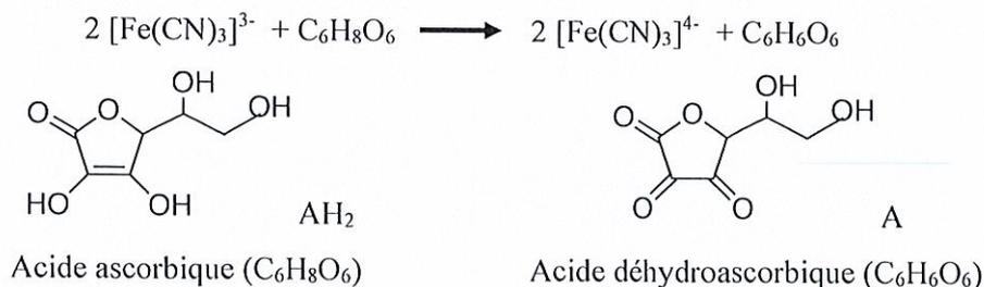
On mélange 20 mL d'une solution contenant l'acide ascorbique ( $5 \cdot 10^{-4} \text{ molL}^{-1}$ ) avec 20 mL d'une solution contenant l'hexacyanoferrate (III) ( $10^{-3} \text{ molL}^{-1}$ )
