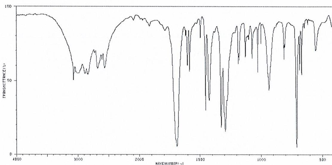
Spectre IR B : acide benzoïque ou alcool benzylique ?
