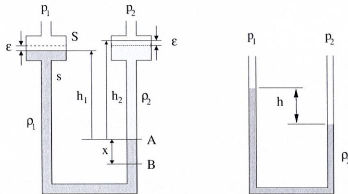
1. Lorsque les pressions  $p_1$  et  $p_2$  sont égales à la pression atmosphérique (manomètre ouvert par exemple), l'interface des deux liquides de masse volumique  $\rho_1$  et  $\rho_2$  se trouve en A et les surfaces libres des deux liquides sont respectivement situées à des hauteurs  $h_1$  et  $h_2$  par rapport à A (voir figure). Donner la relation entre  $h_1$ ,  $h_2$ ,  $\rho_1$  et  $\rho_2$ .
