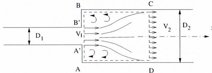
1. Exprimer la perte de charge  $\Delta H$  produite à l'élargissement brusque entre les sections  $AB$  et  $CD$  en fonction de  $\rho$ ,  $g$ ,  $p_1^*$ ,  $p_2^*$ ,  $V_1$  et  $V_2$ .
