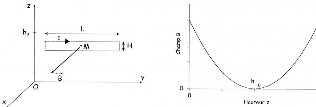
Un cadre métallique de hauteur  $H$ , de largeur  $L$  et de centre  $M$ , contenu dans le plan  $\widehat{yOz}$ , est parcouru par un courant  $I$  positif (schéma de gauche). Ce cadre baigne dans un champ magnétique statique (schéma de droite) orienté suivant l'axe  $\vec{u}_x$  et non uniforme selon la direction verticale  $\vec{u}_z$  :
